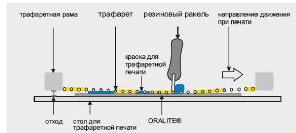
Для выполнения печати мы рекомендуем среднюю скорость печатных ракелей примерно 0,75 м/сек. и позиционирование ракелей под углом 30° к поверхности, на которую наносится печать.
