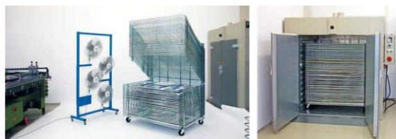
Дальнейшая оптимизация условий просушивания возможна при использовании конвекционных печей. Эти закрытые системы обеспечивают обессыпанную фазу просушивания при постоянной температуре, низкой влажности воздуха и отсутствии нагрузки на пользователя посредством воздействия паров растворителей.
