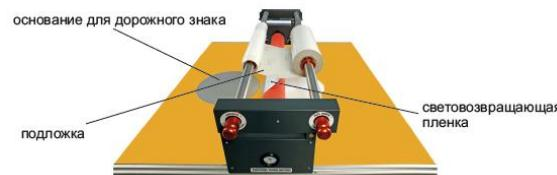
В случае обработки параллельно нескольких пленочных полос они всегда должны склеиваться внахлестку. Перехлест, в зависимости от формата, должен составлять от 3 до 5 мм, и при этом следует обращать внимание на то, чтобы пленочные полосы всегда склеивались правая сторона с левой, благодаря чему обеспечивается единая ориентация ячеистой структуры пленки.
