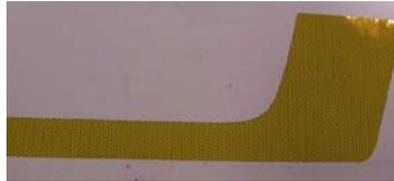
La pieza original se debe cortar de tal manera que permita que las piezas más pequeñas resultantes se puedan aplicar individualmente sobre superficies curvas simples y con poca profundidad, evitando curvaturas complejas de la superficie: Una vez que la pieza está cortada en partes más pequeñas, deberá aplicarse siguiendo los siguientes pasos:
