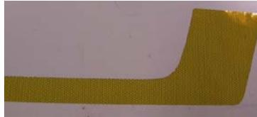
Um komplexere Biegungen zu umgehen, wird eine Aufteilung in kleinere Segmente empfohlen. Die entstandenen Einzelzuschnitte werden dann auf den Oberflächenwölbungen aneinandergefügt. Nach dem Zuschneiden werden die Einzelsegmente wie nachfolgend dargestellt aufgebracht:
