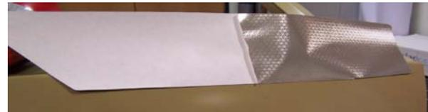
Bringen Sie die den Folienabschnitt von der Mitte her auf, um einen Druckaufbau und Luftkanäle zu vermeiden.
