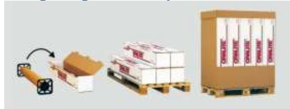
ORALITE®-Reflexfolien sollten an einem kühlen und trockenen Platz, geschützt vor direkter Sonneneinstrahlung gelagert werden. Wir empfehlen Temperaturen im Bereich von 20° C bis 24° C und eine relative Luftfeuchtigkeit von 40% bis 60%.
