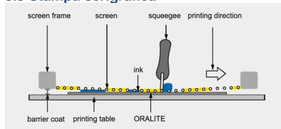
Prima di iniziare il processo di stampa serigrafica, pulire telaio, racle e raschietto con un solvente adatto. Inoltre, ogni pellicola sottoposta a stampa deve essere prima pulita con un panno anti-polvere o anti-statico.
