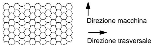
Le pellicole ORALITE® High Intensity Prismatic Grade sono conformi con i dati minimi di riflettenza nella direzione della macchina, oltre che in direzione trasversale.
