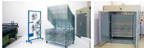
L'asciugatura può essere ulteriormente ottimizzata attraverso l'utilizzo di forni a convenzione. Questi sistemi chiusi rendono possibile effettuare l'essiccazione delle pellicole a temperatura costante, con un tasso ridotto di polvere e umidità, senza esporre l'operatore ai vapori dei solventi.
