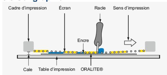
Avant l'impression, il faut nettoyer l'écran, la racle d'impression et la racle d'enduction avec un solvant approprié. Il faut en outre essuyer chaque film avec un chiffon antipoussière ou antistatique.
