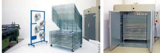
L'emploi d'étuves à convection est une autre possibilité d'optimisation des conditions de chauffage. Ces systèmes clos assurent un séchage à faible contamination en poussière, avec une température très constante, une faible humidité et sans exposer l'opérateur à des vapeurs de solvants.
