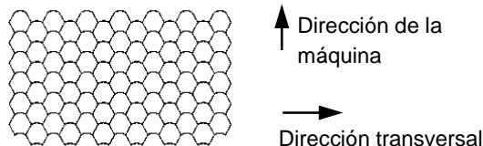
Las películas ORALITE® High Intensity Prismatic Grade cumplen con los datos reflectantes mínimos relevantes en la dirección de la máquina y en dirección transversal.
