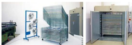
Otro método para optimizar las condiciones de secado es el uso de hornos de convección. Estos sistemas cerrados permiten un secado con reducido nivel de polvo, con una temperatura constante y baja humedad del aire. Además, no exponen al usuario a los vapores de disolventes.
