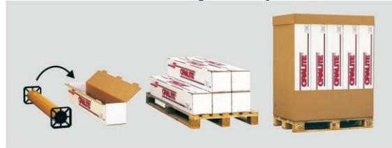
Las películas reflectantes ORALITE® de la clase de reflexión RA2,B deben almacenarse en un lugar cerrado, fresco y seco, protegido de la radiación solar directa. Recomendamos temperaturas de almacenamiento comprendidas entre 20° C y 24° C y una humedad relativa del aire de entre un 40% y un 60%.
