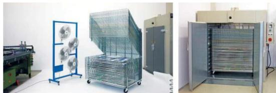
Eine weitere Optimierung der Trocknungsbedingungen ist durch den Einsatz von Konvektionsöfen möglich. Diese abgeschlossenen Systeme ermöglichen eine staubarme Trocknungsphase bei konstanter Temperatur, geringer Luftfeuchtigkeit und ohne Belastung des Anwenders durch Lösungsmitteldämpfe.
