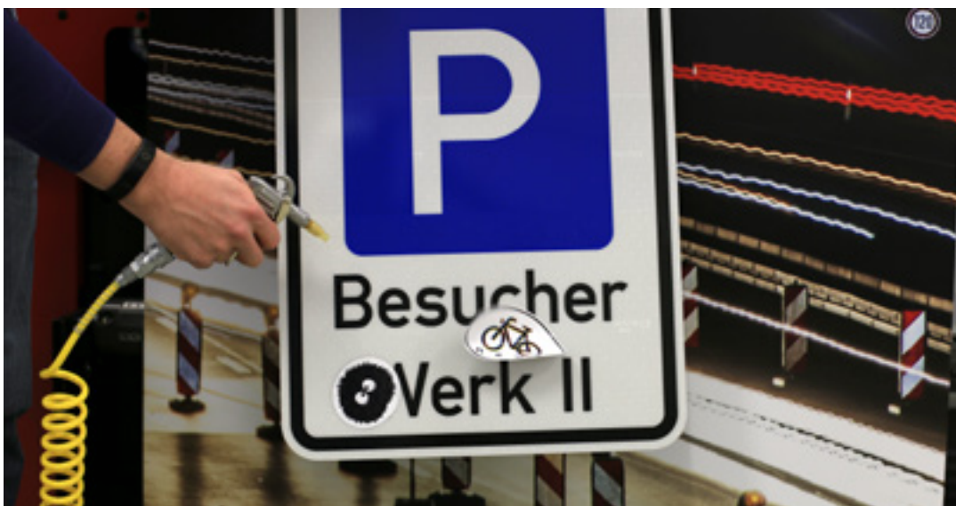
Aufkleber auf Verkehrszeichen mit Schutzlaminat, die teilweise durch Wind hier simuliert mit Druckluft abgelöst werden.
