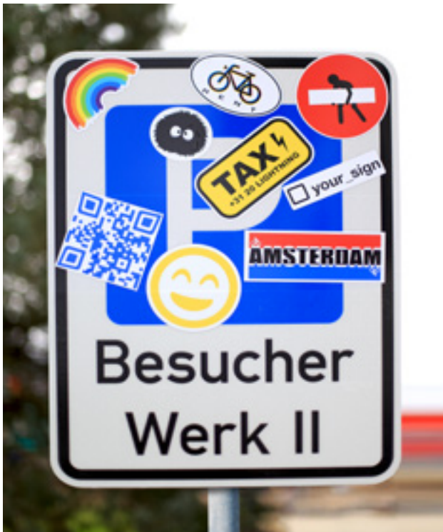
Verkehrszeichen ohne Schutzlaminat mit stark beklebter Oberfläche
